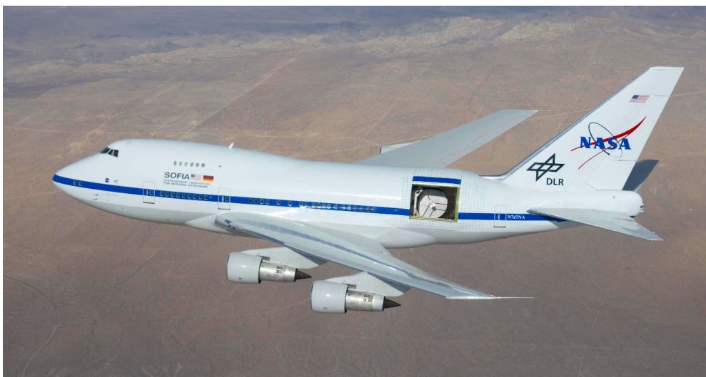
Abbildung 2: SOFIA ist ein modifizierter Boeing „Jumbo-Jet“ mit einem 2,5-m Spiegelteleskop zur Messung von Infrarot-Strahlung, für die die Erdatmosphäre nicht durchlässig ist. Die Beobachtungen von NIRS3 erfolgten während zweier Flüge im Frühjahr 2016 (Bild ©NASA).
